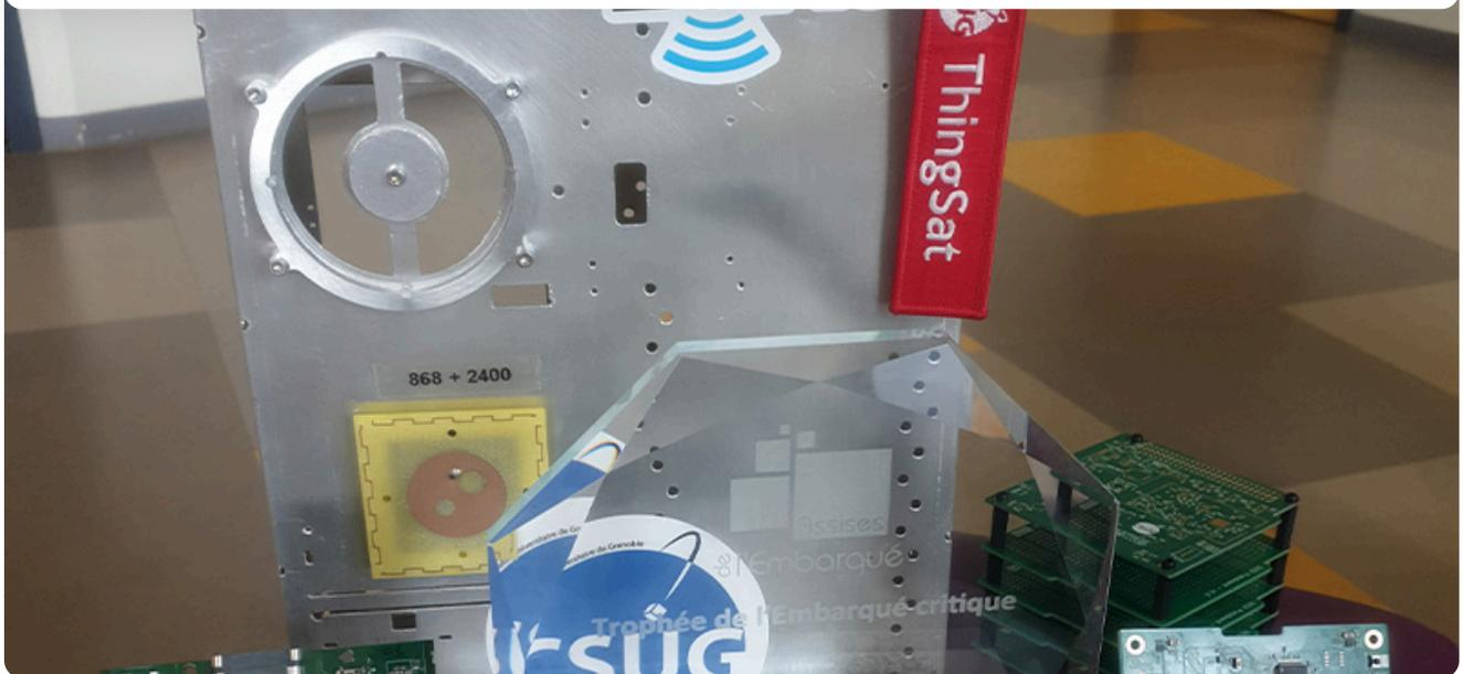
Le dispositif évalue des protocoles pour des communications longue distance avec la modulation LoRa à faible consommation d'énergie pour les services IoT bidirectionnel par satellite.
